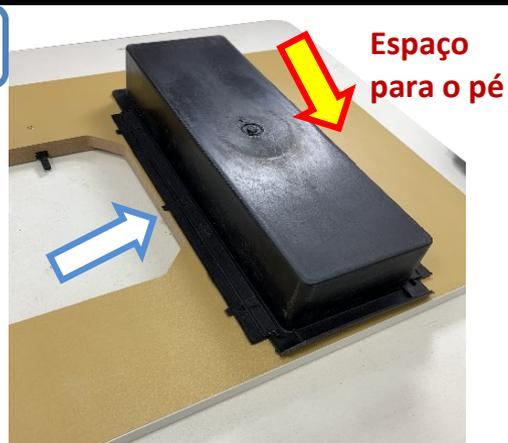
Posicionar as corredeiras da gaveta na parte da frente do tampo (lado oposto das dobradiças), deixando ela bem encostada na abertura da máquina para que haja espaço para os pés de ferro na parte de fora.
