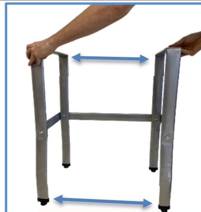
Depois de posicionar os parafusos só com a mão, coloque o pé montado no chão e alinhe na mesma distancia encima e embaixo.
