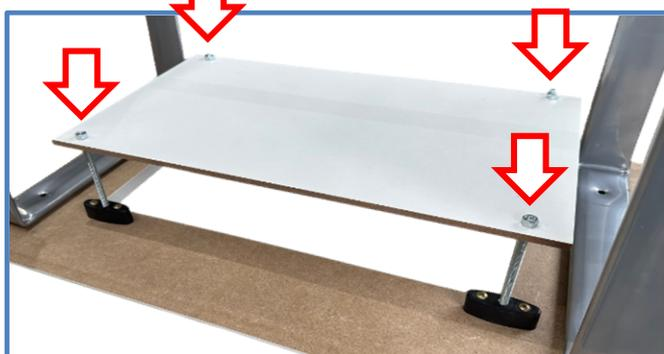
Coloque a base da máquina apoiada nos 4 parafusos e porcas, rosqueie as porcas de cima. Só aperte após finalizar a montagem e regular a altura da sua máquina.
