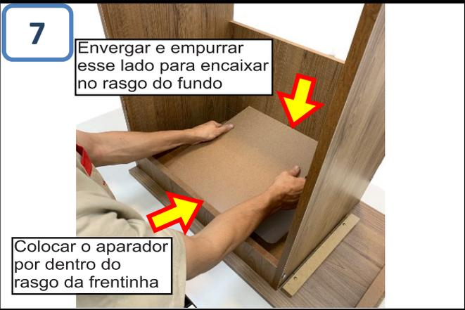
O aparador de óleo será colocado sob pressão dentro dos rasgos da frentinha e do fundo do móvel. Apoie um lado do aparador em um rasgo e empurre o outro lado para encaixar.
