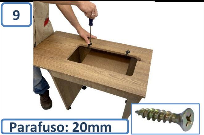
Mesaleta montada. Coloque ela em pé e parafuse as duas dobradiças em seus respectivos locais na tampa do móvel.
