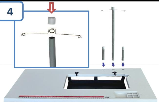
Monte a torre central do porta cone conforme indicado acima, depois, encaixe os 3 tubos sob pressão.
